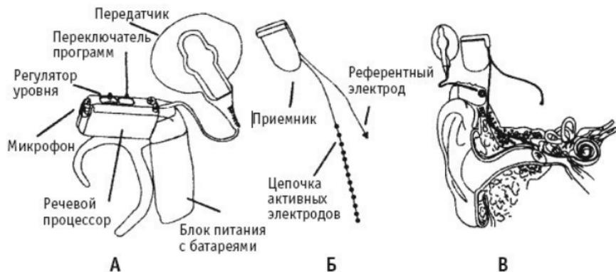
Рис. 4. Устройство кохлеарного импланта на примере системы «OPUS 1» (MED-EL, Австрия): А – внеш-
