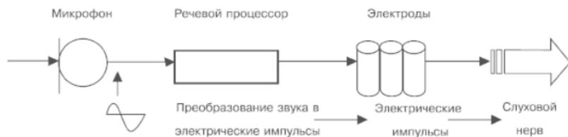
Рис. 3. Сравнение принципа действия кохлеарного импланта и слухового аппарата
